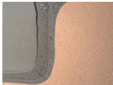
Verbindung Cu- mit Ti-Legierung Pos. 4⇒5
