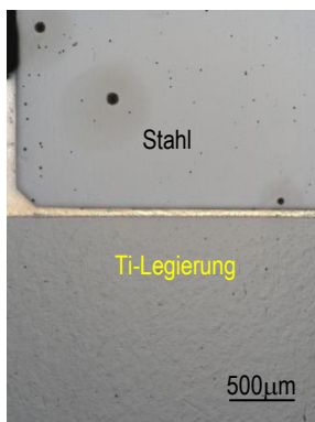
Verbindung Stahl mit Ti-Legierung Pos. 1⇒2
