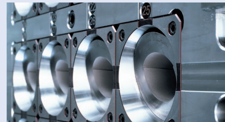
Mehrfachwerkzeug mit vakuumgelöteten Formeinsätzen, Bild: FOBOHA GmbH
